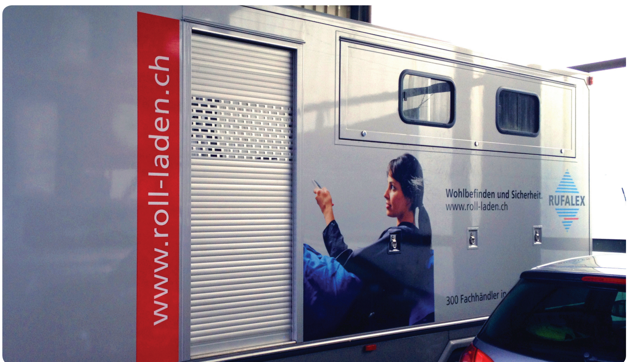
Abb. 101: Sicherheitsrollladen als Türersatz bei Pferdesportwagen
