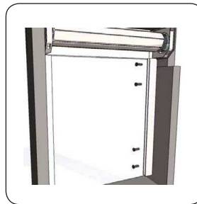
3 Führungsschienen anschrauben, Schraubendefinition gemäss Merkblatt
