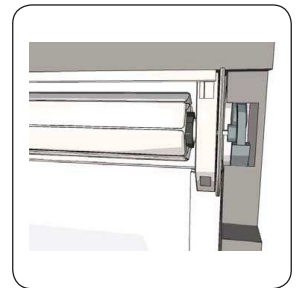
4 Getriebe mit Schraubenzieher durch vorgesehene Öffnung im Abweisblech seitlich positionieren
