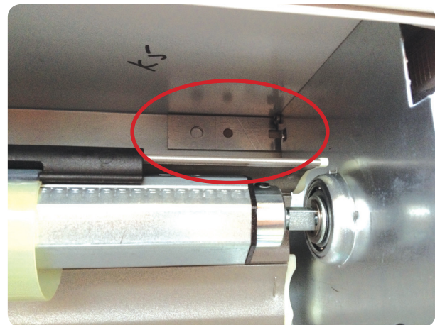
Abb. 86: Befestigungslasche zur Fixierung des Kassettensystems
